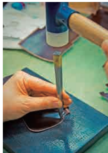
ピッチの間隔が狭いため、重ねて菱目を打つと上下の革の穴の大きさに差が出てしまう。そのため1枚ずつ個別に穴を開ける。
