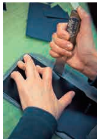
革パーツに貼り合わせるビッグスキンをハンドカットしている図。見えない部分にまでこだわり抜く。
