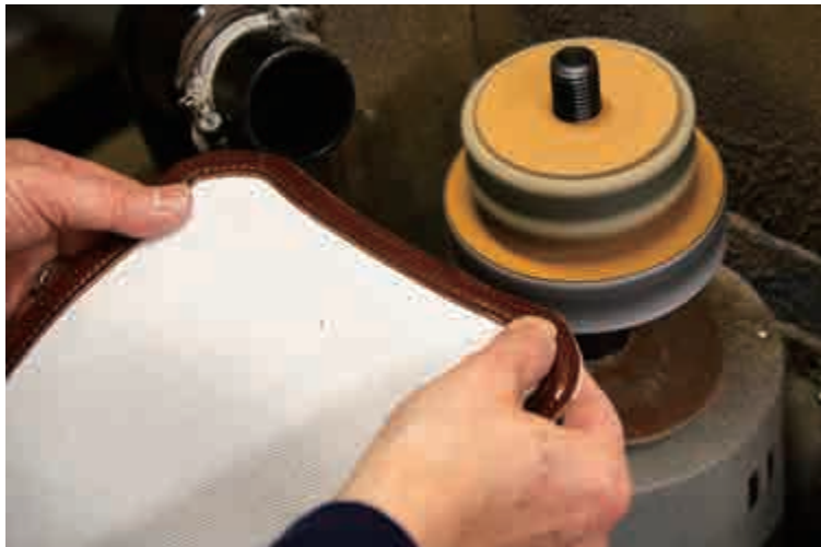
ウォレットのコバは専用マシンで整えた後、職人が時間を掛け、手作業で磨き上げていく。
