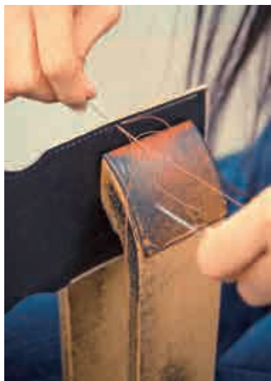
個別に穴を開けた革パーツを複数枚重ね、縫い針で穴を探りながら縫い合わせていく。穴の微細なスレも許されない。
