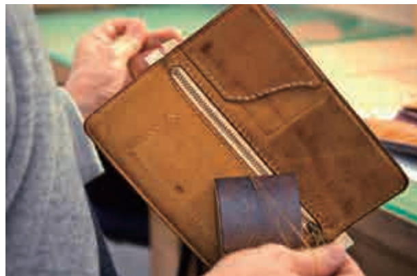
ハンドメイドで仕立てられるレザープロダクトは、リペアしながら長年使い続けることが可能となる。写真はウォレットのジッパーを交換しているところ。
