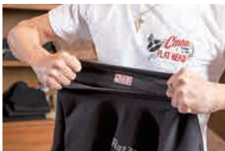
THCでは20番手の太い綿糸を使っているため、ネックを伸ばしても洗濯・乾燥により復元する。一般的なポリエステル糸は一度伸びると復元しない。
