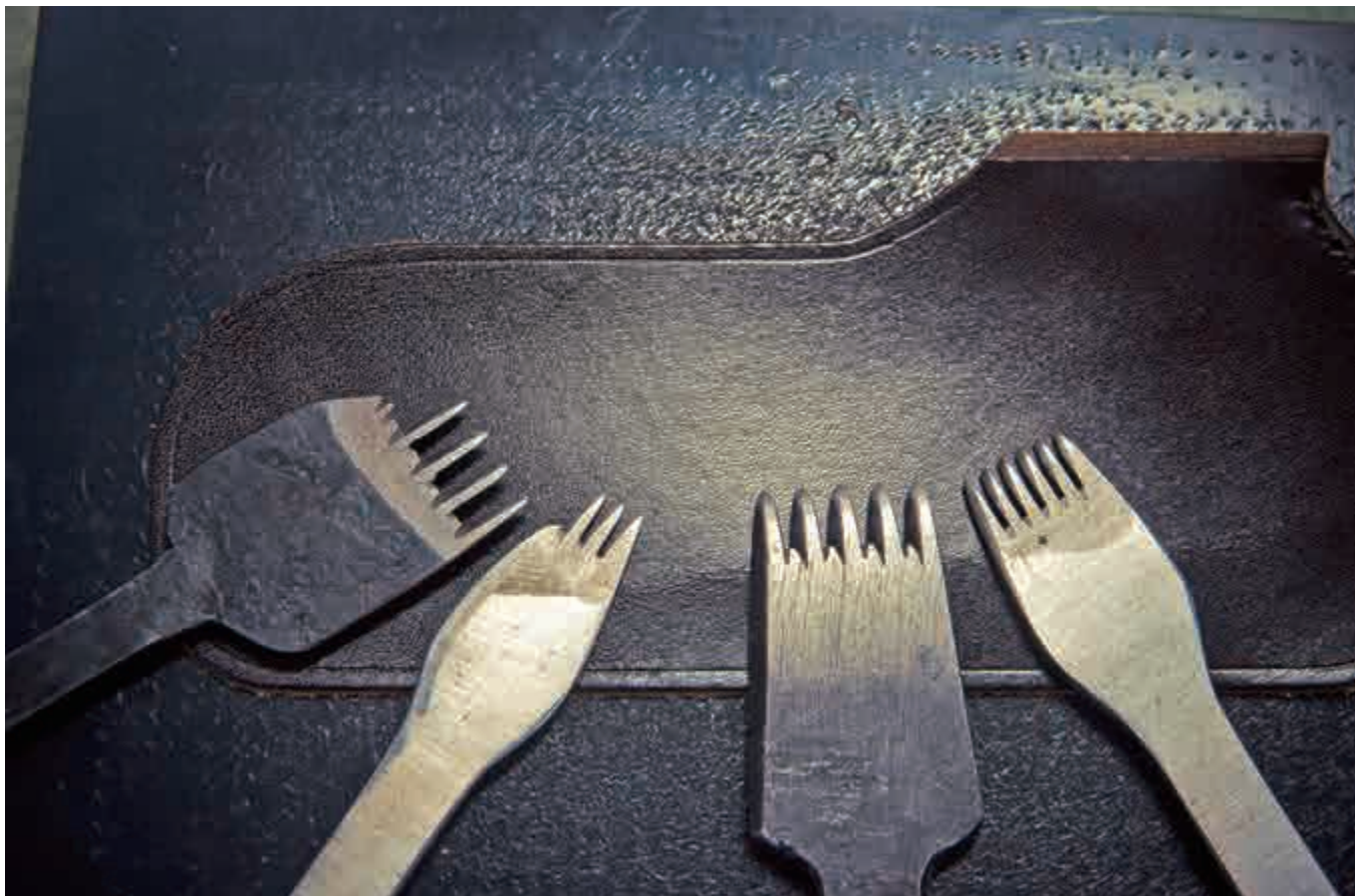
極細ピッチを実現するためにカスタムされたオリジナルの菱目打ち(左側2本)。一般的な菱目打ちよりも小さな穴が開くように工夫されている。
